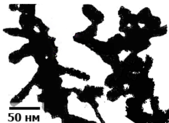
Рис. 4.15. Мікрофотографія наночастинок карбонату кальцію
