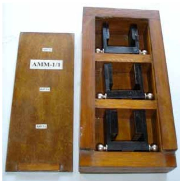
Рис. 2.4. Магнітний аналізатор (ліворуч) і набір магнітів для нього (праворуч):
